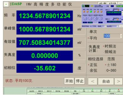
图 5 (b) 东方所高精度多功能仪
